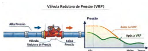
A gestão da pressão consegue-se através da instalação de Válvulas Redutoras de Pressão (VRP)
